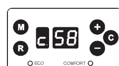
Het display van de DMF04. De extra "C-toets" geeft duidelijk het verschil aan met de DMF02.
