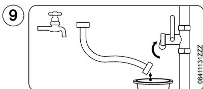
Koppel de slang los van de kranen. Bevestig het dopje weer op de cv-vulkraan.
