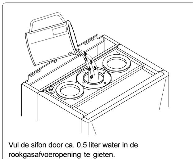
Vul de sifon door ca. 0,5 liter water in de rookgasafvoeropening te gieten.
