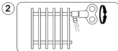
Gebruik het ontluchtsleuteltje. Begin bij de laagstgelegen radiatoren. Eindig op de bovenverdieping. Ontlucht tot er geen lucht meer uit komt.
