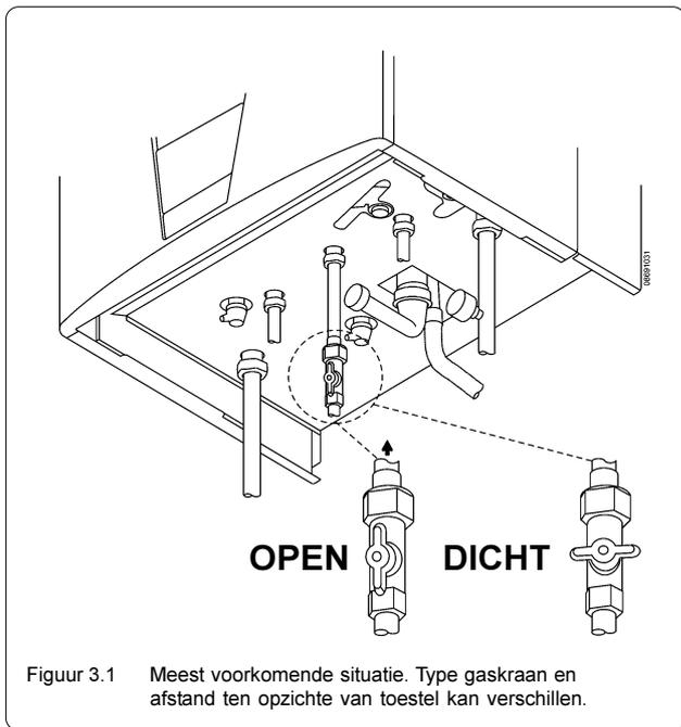
Figuur 3.1 Meest voorkomende situatie. Type gaskraan en afstand ten opzichte van toestel kan verschillen.
