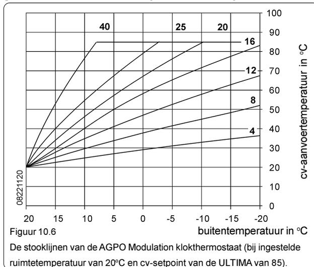
Roep het installateursmenu van de Modulation op door enige seconden tegelijkertijd op de knoppen "OPSTAAN" en "SLAPEN" te drukken. Als u hierna enkele malen op de knop "i" drukt, ziet u de parameter HC met de waarde 16. **Stel de gewenste stooklijn in** met de pijltjes toetsen. Druk weer tegelijkertijd op de knoppen "OPSTAAN" en "SLAPEN" om uit dit installateursmenu te gaan.
