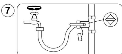
Draai de waterkraan langzaam open. Sluit de waterkraan als de druk 1,6 bar is.
