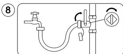
Ontlucht de installatie nogmaals (zie punt 2) en vul zonodig bij. Sluit de cv-vulkraan.
