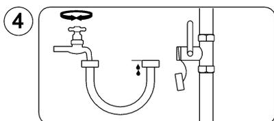
Draai de kraan langzaam open en vul de slang met water. Sluit de kraan als de slang vol is.
