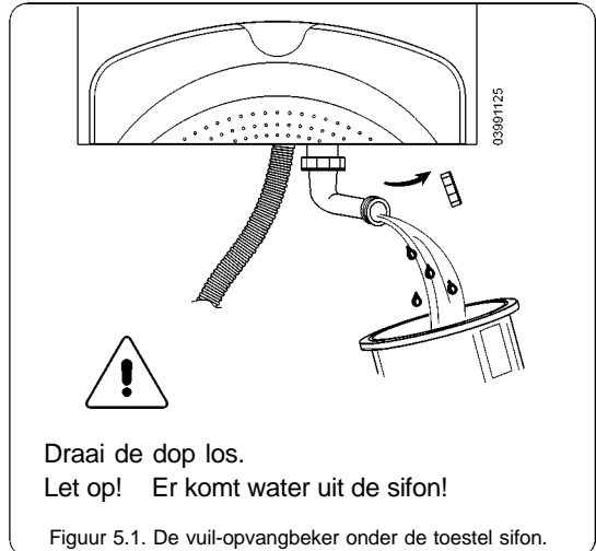
Figuur 5.1. De vuil-opvangbeker onder de toestel sifon.
