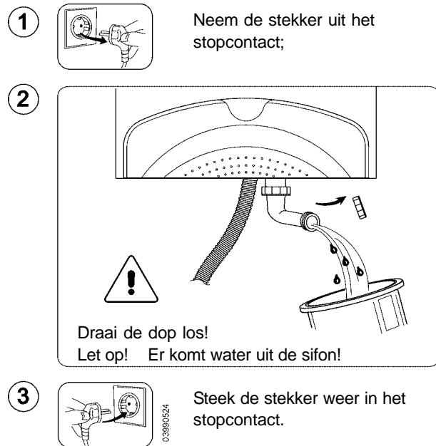
Figuur 5.1. De vuil-opvangbeker onder de toestel sifon.
