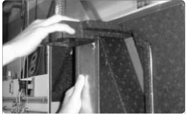
Figuur 15-3. Verwijderen van de vulplaat.
